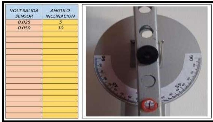
Con los datos ya registrados procedemos a determinar la linealidad del sensor graficando, por medio de un plano cartesiano la relación entre los vectores voltaje del sensor y el ángulo de inclinación, ejemplo figura 8.
