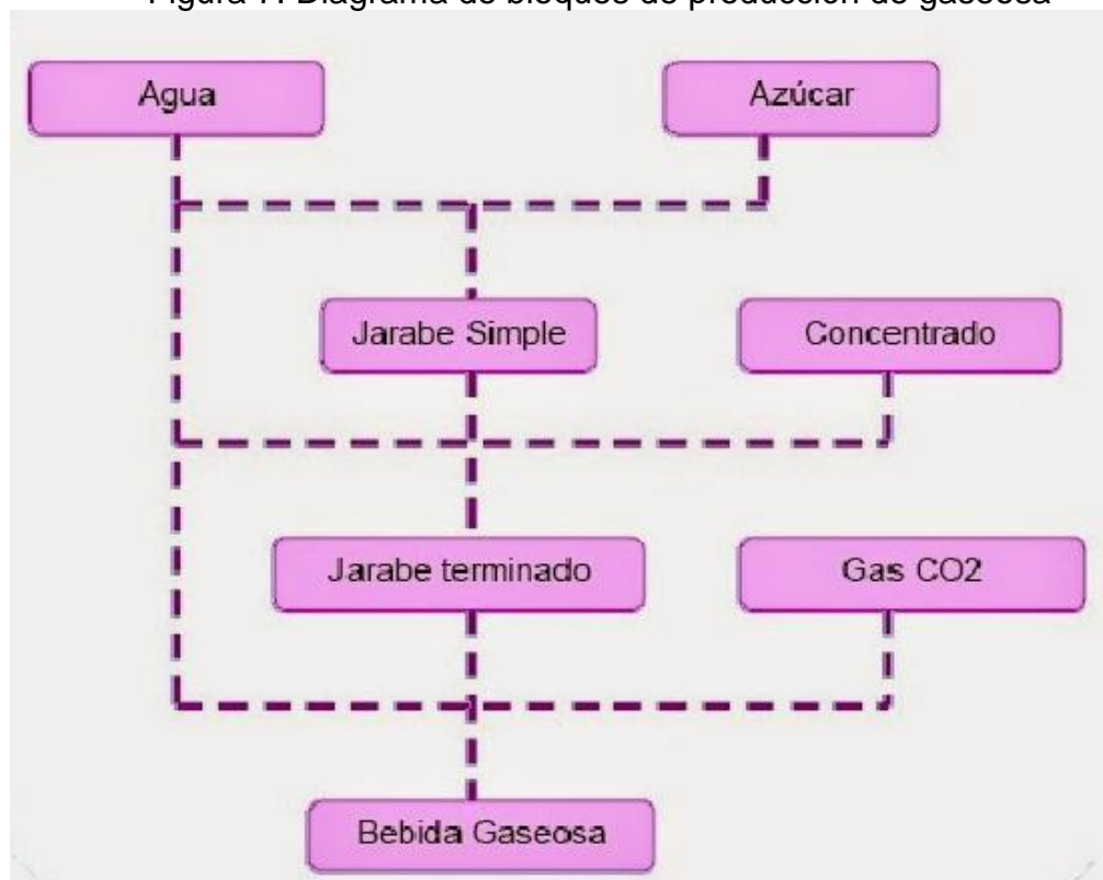
Figura 7. Diagrama de bloques de producción de gaseosa
