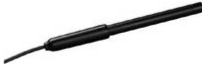
Figura 20. Sensor de oxígeno disuelto vernier.
