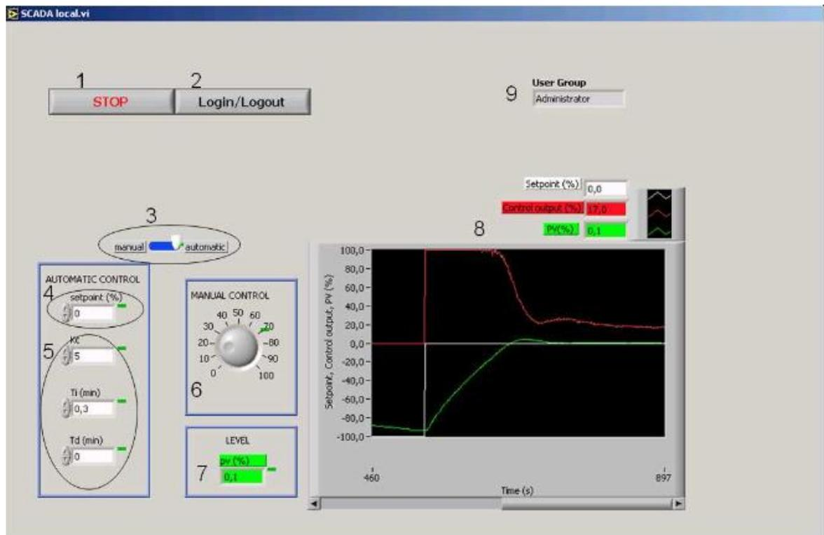
Figura 1. Sistema Scada en Labview para laboratorio de control.
