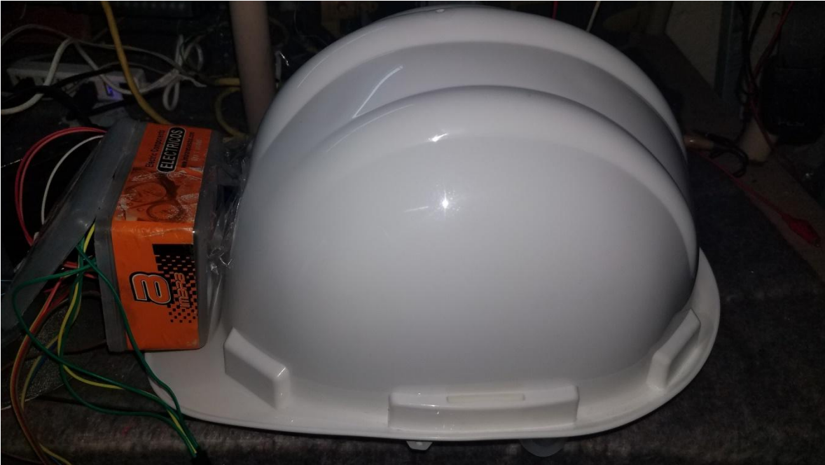
Imagen 11 casco conectado a los sensores y Bateria litio polimero 1000 - 7.4 V de drone para hacerlo portable la carga dura 4 a 6 horas con los sensores 22
