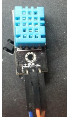
Imagen 2. Sensor humedad y temperatura 4
