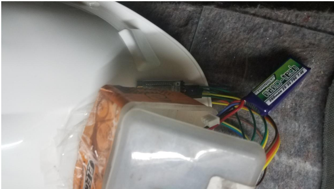
Imagen 12 batería Bateria recargable con tecnología lipo, 1000mAh, Voltaje de salida 7,4V.Descarga: 25C-50C constante. 23
