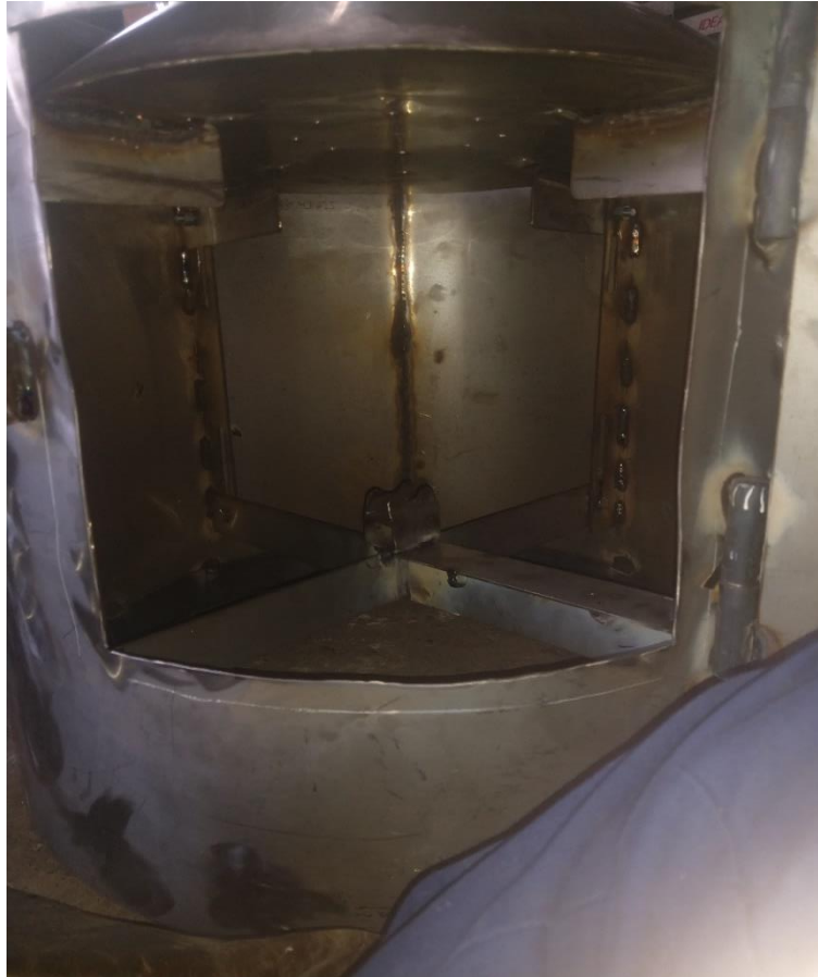
Figura 29. Base para la boquilla de aspersión de vitamina. Fuente: los autores
