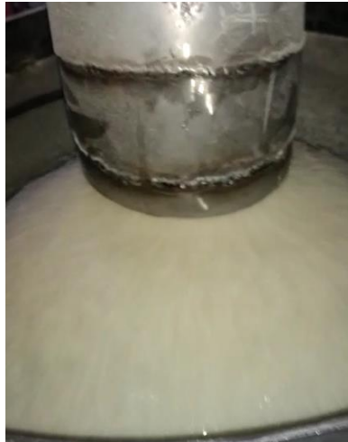
Figura 46. Formación de cortina de arroz en forma cónica. Fuente: los autores.
