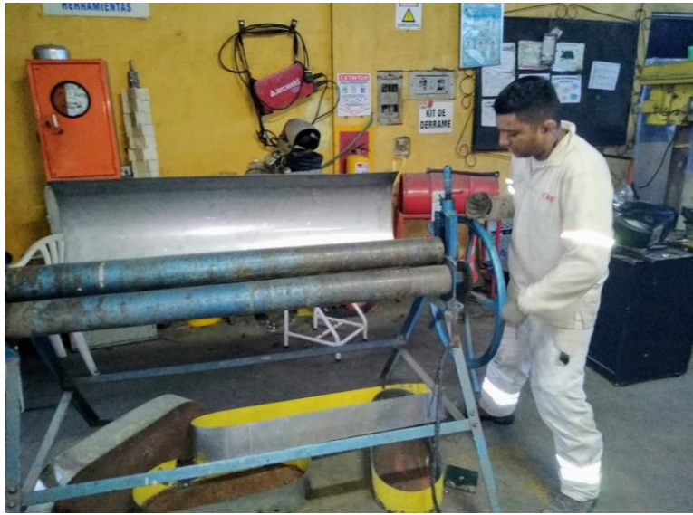
Figura 32. Enrolamiento de tubería de 7" en acero inoxidable. Fuente: los autores.
