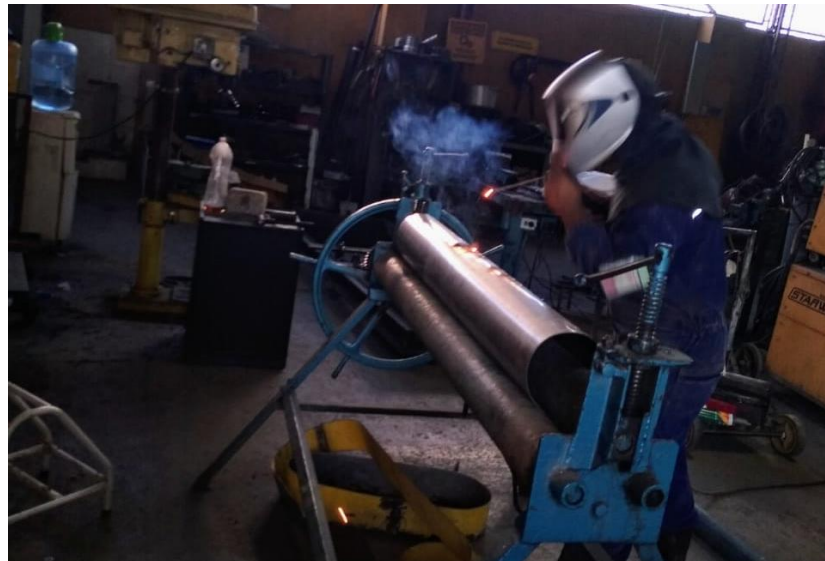
Figura 33. Fabricación tubería de 7". Fuente: los autores.
