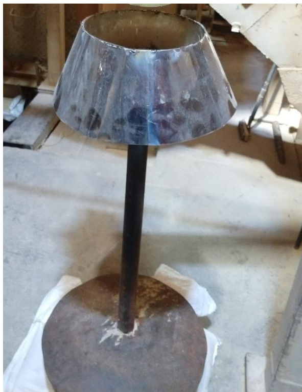
Figura 26. Bandeja cónica de ensayos de dispersión del grano. Fuente: los autores
