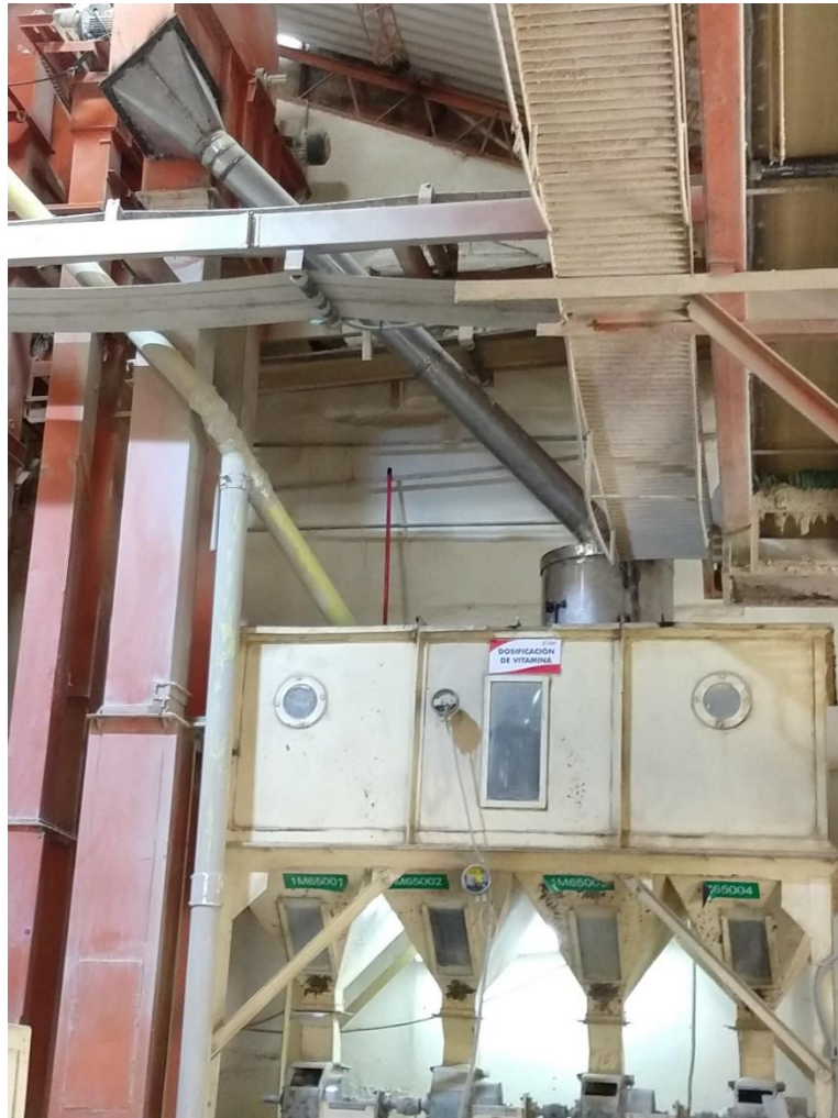
Figura 34. Montaje del bajante y del sistema aspersor de arroz. Fuente: los autores.
