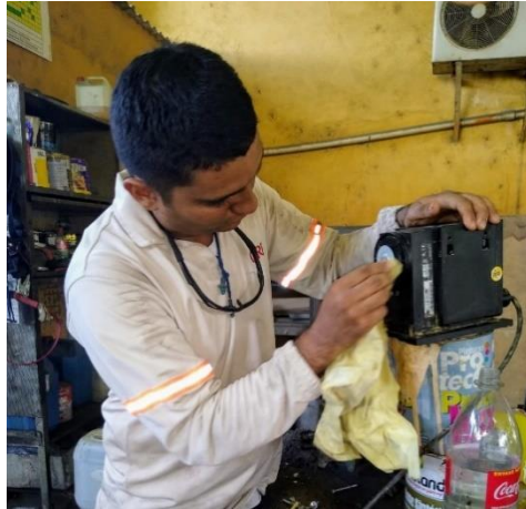
Figura 36. Mantenimiento de bomba dosificadora. Fuente los autores.
