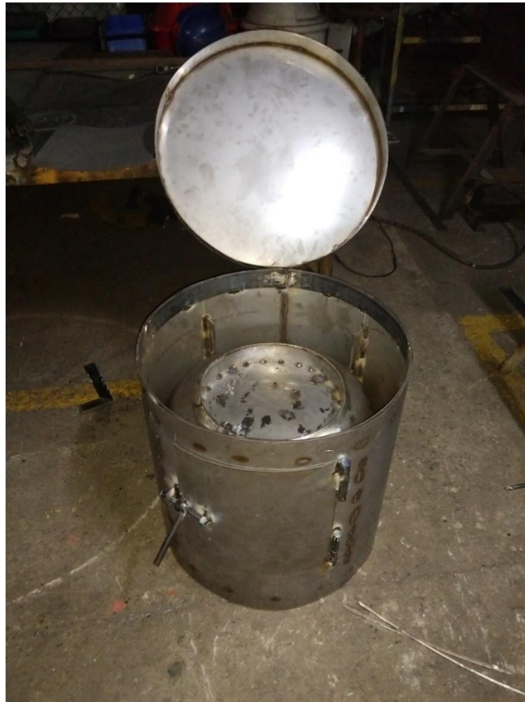
Figura 28. Dispositivo aspersor de arroz y generador de cortina de arroz. Fuente: los autores.
