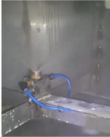
Figura 45. Aspersión de vitamina en el nuevo sistema de dosificación. Fuente: los autores.
